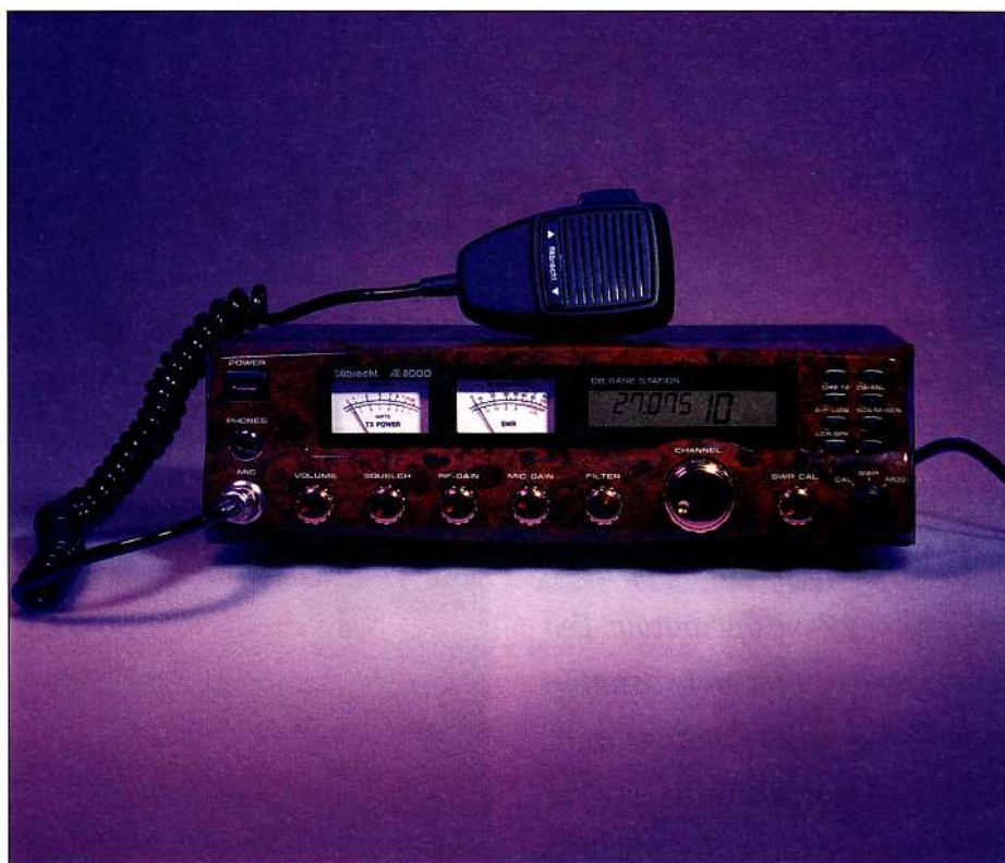
De AE-8000 heeft een ingebouwd packetradio-modem.
